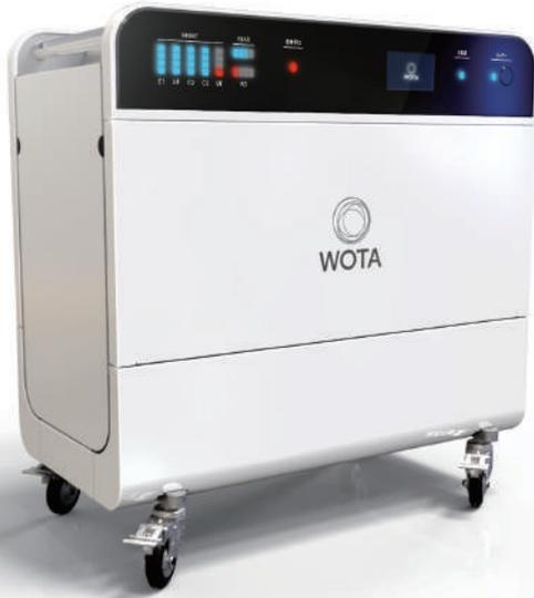
「WOTA BOX」は、シャワーをはじめ様々な水回り設備に接続可能な水循環システムです。AI水循環の技術により、水を高い効率でろ過して繰り返し循環させることで、シャワー 50L あたりの排水を 1L 以下に抑えられるため、100L の水で約 100 回のシャワー入浴を実現します。配管工事が不要で電源さえ確保できれば短時間で設置して快適な水をお使い頂けるため、災害時をはじめとして活用が期待されています。
